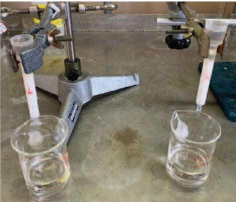
Différentes concentrations d'acide nitrique sont ensuite passées à travers la résine afin d'éliminer les potentiels éléments interférents puis le  $^{90}\text{Sr}$  est élué et isolé de sa fille  $^{90}\text{Y}$ .
