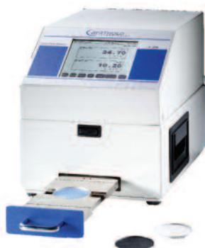
Basé sur un détecteur solide au ZnS, la mise en œuvre du **LB 2046** est rapide et son poids de seulement 13,5 kg, grâce à un blindage uniquement composé d'acier, permet de facilement le déplacer. Il offre des rendements de **27%** pour le  $^{241}\text{Am}$  et de **40%** pour le  $^{36}\text{Cl}$ . Pour une heure de mesure, les limites de détection sont de l'ordre de **0,03 Bq** en alpha et de **0,06 Bq** en bêta.
