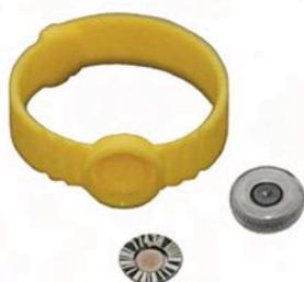
**dxtRAD** est un système intégré de mesures dosimétriques d'extrémités par thermoluminescence. Les bagues plastiques, à usage unique, sont très confortables et s'ajustent avec précision au diamètre du doigt. L'élément dosimétrique est indissociable de son identification, garantissant ainsi la traçabilité parfaite de l'information. L'ensemble est automatisable et utilisé pour la lecture sur des lecteurs thermoluminescents.
