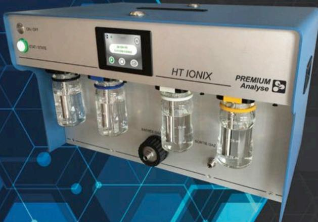
**Prélèvement du tritium sous forme de vapeur d'eau (HTO) ou sous forme de gaz (HT) après oxydation dans un four catalytique.**
