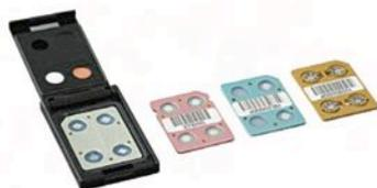
Un dosimètre est obtenu en associant une carte, recevant les éléments sensibles (FLi), et un badge qui, en assurant la protection de la carte et son port, fournit les filtrations grâce auxquelles les signaux mesurés seront transformés en grandeurs dosimétriques.
