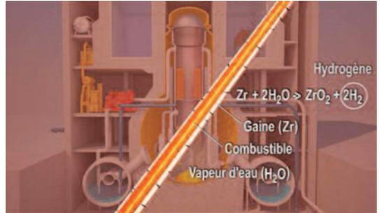
Figure 2 - Production d'hydrogène à partir du zirconium de la gaine entourant le combustible à base d'uranium
