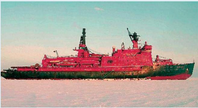
Figure 3 - Brise-glace soviétique Arktika mis en service en 1974 et équipé de deux réacteurs à eau pressurisée OK-150 utilisant de l'uranium-235 enrichi comme combustible
