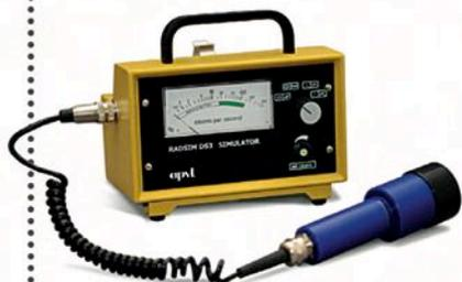
Le **RADSIM DS3** est un simulateur de contamination adapté aux formations à la prévention des risques des personnes travaillant avec des sources radioactives et/ou sur site nucléaire, sans s'exposer réellement à ces sources. En mesurant la fluorescence des colorants contenus dans les simulateurs, ce simulateur illustre les phénomènes radioactifs et de transfert de contamination. Le **RADSIM DS3** est livré avec des produits de simulation rinçables à l'eau.
