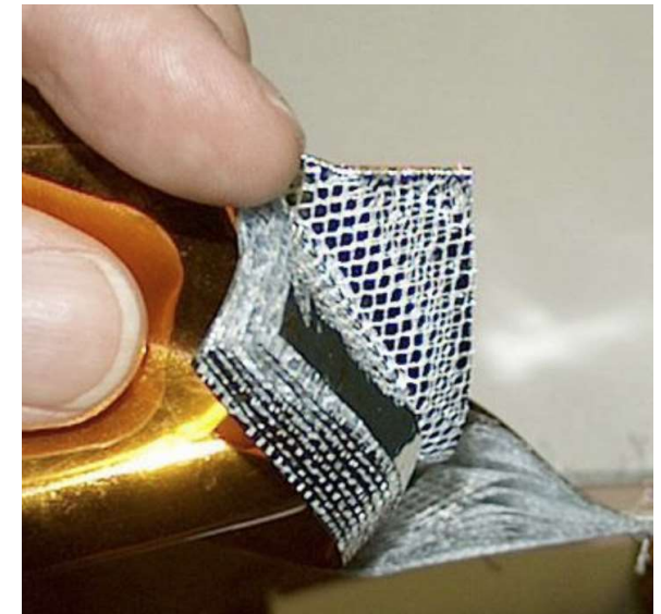
Fig. Zoom sur l'intérieur d'un isolant multicouche [8]
