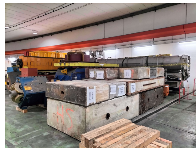
Blocs de blindage en béton et autres objets massifs.
